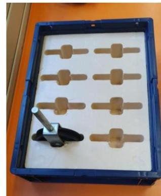
Figure 13 Support roulette usiné
