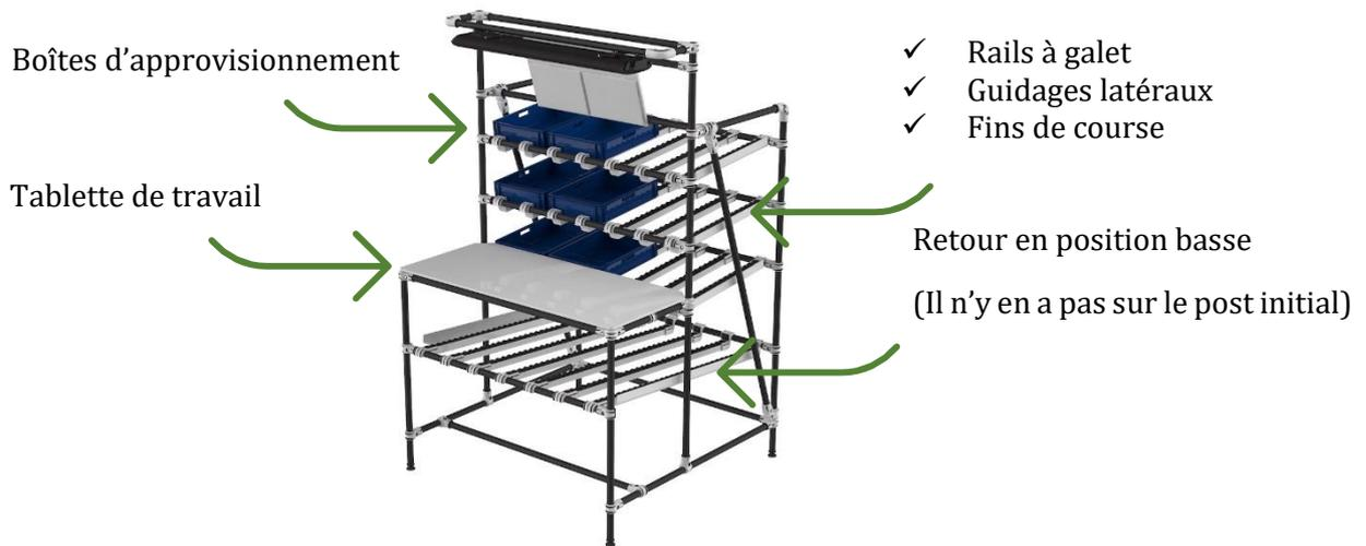
Les postes de la ligne de stepper sont construit sur le même modèle avec un rail à galet permettant de faire circuler le stepper le long de la ligne et de l'assembler sur un support dynamique. Il possède également un rail de retour en position basse qui permet de faire revenir les support d'assemblage vie que premier poste.
