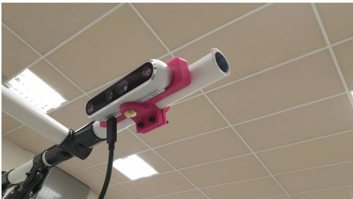
Figure 24 : Support 2 imprimé en 3D et monté sur la ligne
