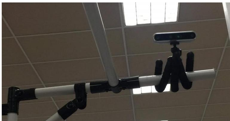
Figure 18 : Caméra intel realsense D455 avec support universel
