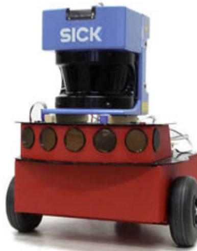
FIGURE 4.1 – Robot *Pioneer 2-DX* avec télémètre laser
