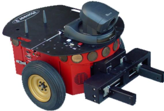
FIGURE 4.4 – Robot *Pioneer 2-DX* avec pince
