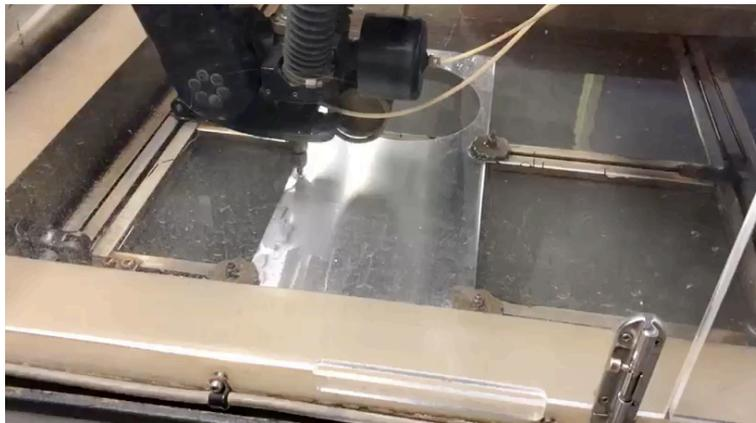
Figure 20 : Découpage de la pièce au jet d'eau.
